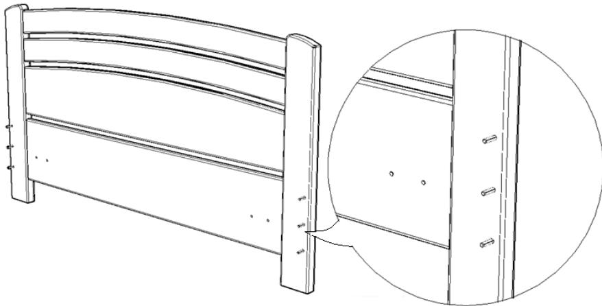
**ШАГ 3.** Прикрутить боковины кровати к изголовью, затем к изножью кровати с помощью стяжек с винтами.
