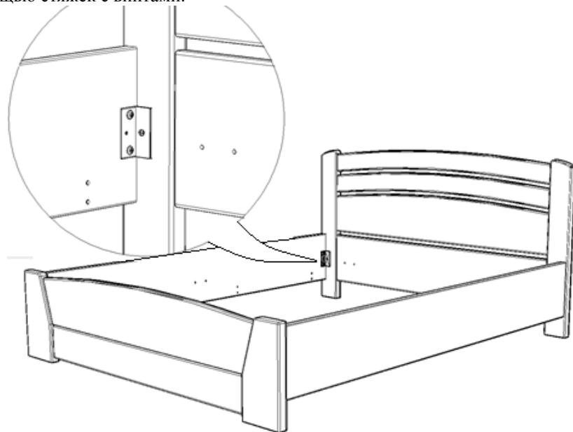
**ШАГ 4.** Прикрепить 2 кронштейна 260x260 в изножье кровати (4 винта на каждый). 4 уголка 508 к изголовью и 2 к боковинам (2 винта на каждый).
