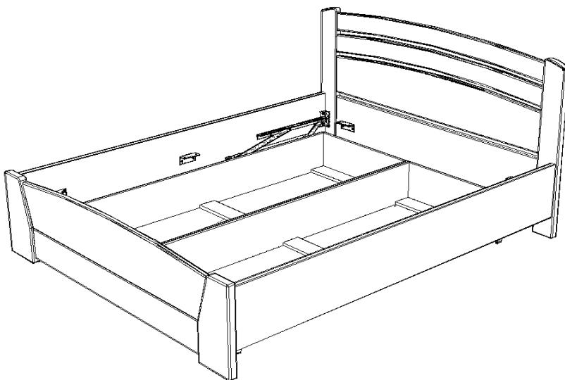
**ШАГ 6.** Вставить металлический ограничитель движения матраса в отверстия на рамке. Прикрутить 4 болтами 6x40 и гайками М6 рамку к механизму подъема.
