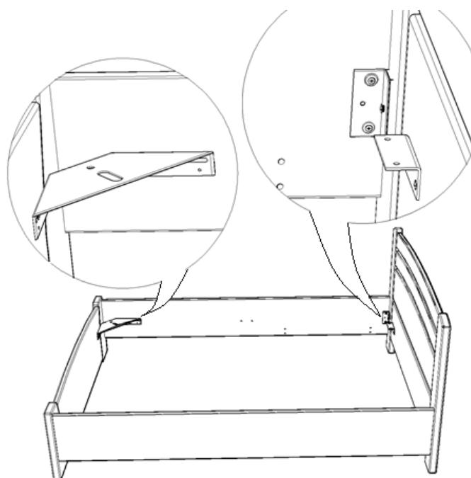
**ШАГ 5.** Прикрепить опору с помощью болта которым она укомплектована к центру рамки и положить рамку на кронштейны, предварительно наклеив на нее подкладки в местах контактов с кронштейнами. (для кроватей без ящика для белья).
