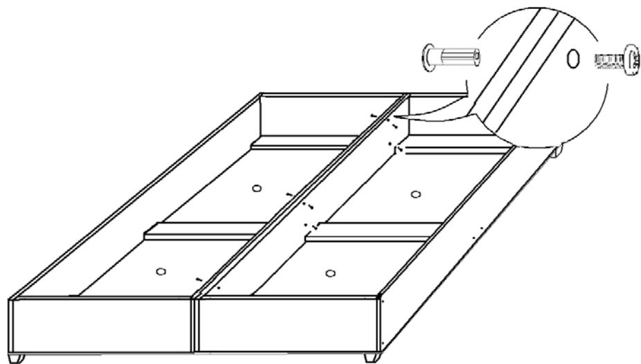
**ШАГ 4.** Прикрепить механизмы подъёма к боковине кровати с помощью винтов 6x16.
