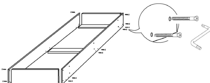
**ШАГ 2.** Прибить гвоздями дно (расстояние между гвоздями оставлять приблизительно 10см). Затем прибить опоры, по четыре, на каждую часть ящика.
